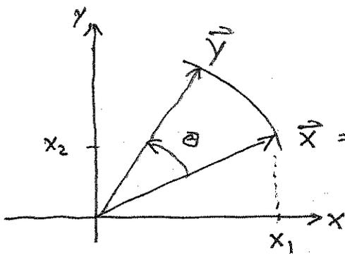
$$\vec{x} = \begin{bmatrix} x_1 \\ x_2 \end{bmatrix} = x_1 \begin{bmatrix} 1 \\ 0 \end{bmatrix} + x_2 \begin{bmatrix} 0 \\ 1 \end{bmatrix}$$
